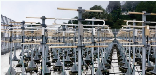
आकृति 62. (ऊपरी) इन-हाउस स्पेयर TRM का निर्माण (निचला) ASTRAD सक्रिय एपर्चर के एक उप-श्रृंखला में इन-हाउस डिजाइन किए गए और निर्मित फोल्डेड-डिपोल का एकीकरण।
