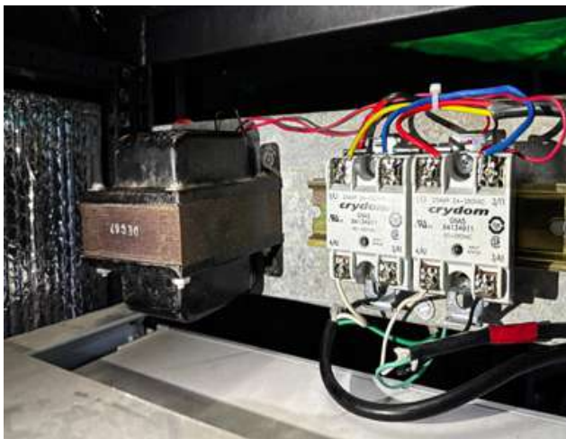
आकृति 91. TANSPEC उपकरण के बाड़े के अंदर लगा SSR रिले।
