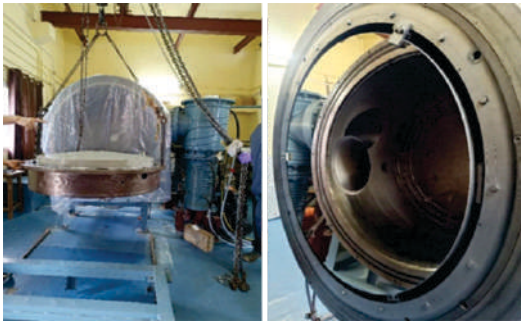
आकृति 89. (बाएं) 104 सेमी. एसटी का प्राथमिक दर्पण कोटिंग कक्ष के अंदर लोड होने के लिए तैयार, (दाएं) नयी एल्यूमीनियम कोटिंग के बाद प्राथमिक दर्पण।
